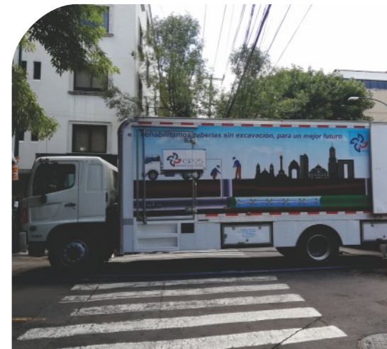
Equipo instalación y curado CIPP-UV I.S.T.
